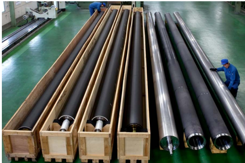
図表 12 長尺カーボンメッキロール(φ 350×9200mm)
